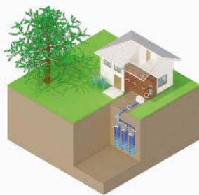
Pompe à chaleur sur corbeilles géothermiques
